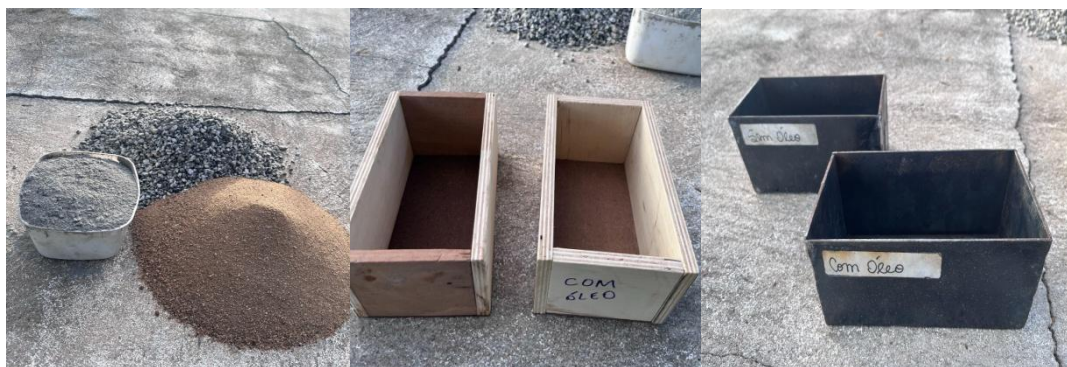
Figura 1: Material do concreto e moldes de concreto em madeira e aço.
