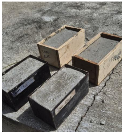
Figura 4: Moldagem das superfícies de concreto sobre a madeira e o aço sem lubrificante e com lubrificante.
