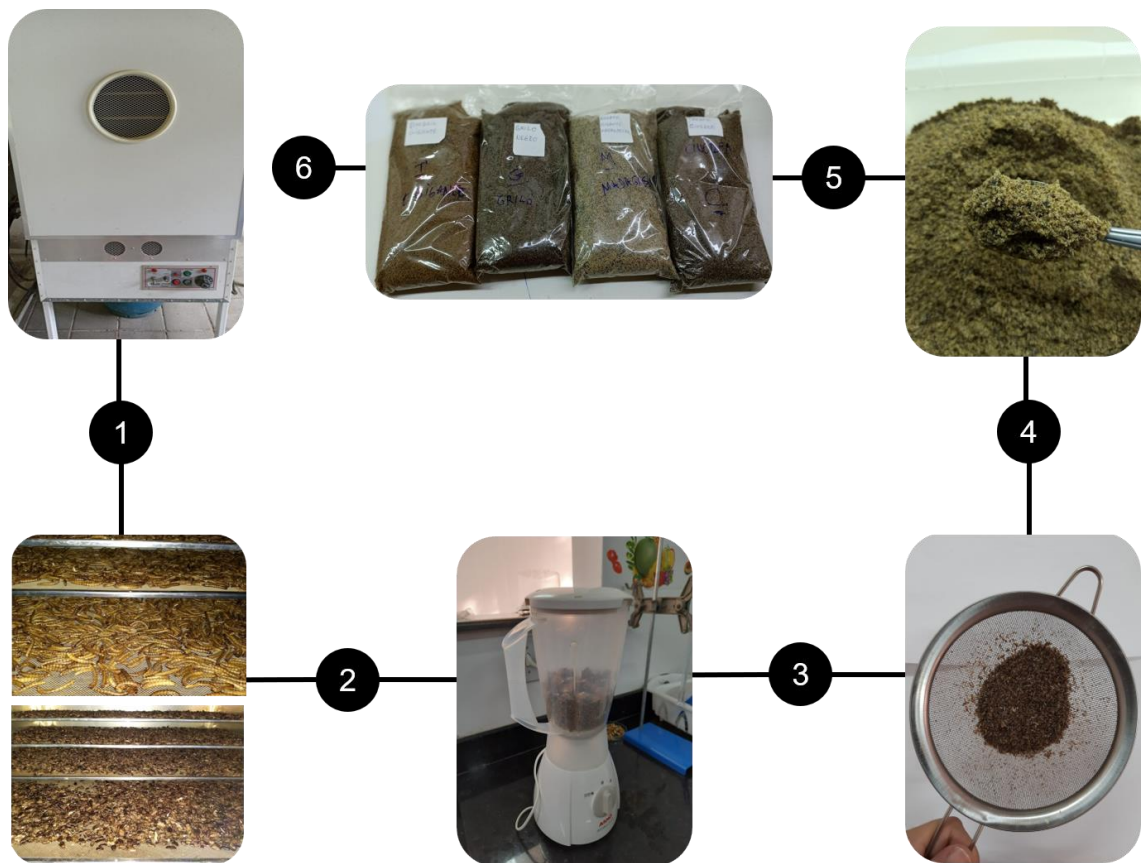
Figura 7: Processo de desidratação no desidratador: (1) Desidratação, (2) Insetos desidratados, (3) Trituração, (4) Peneiração (5) Farinha e (6) Ensacamento.
