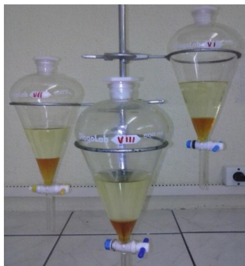
Figura 4: Sínteses VI (40% EtOH / 60% MeOH), VII (30% EtOH / 70% MeOH) e VIII (20% EtOH / 80% MeOH) após 12 horas.
