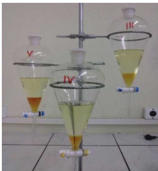
Figura 3: Sínteses III (80% EtOH / 20% MeOH), IV (70% EtOH / 30% MeOH) e V (60% EtOH / 40% MeOH) após 24 horas.
